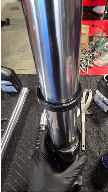
FORK SEAL PROPER ORIENTA TION
